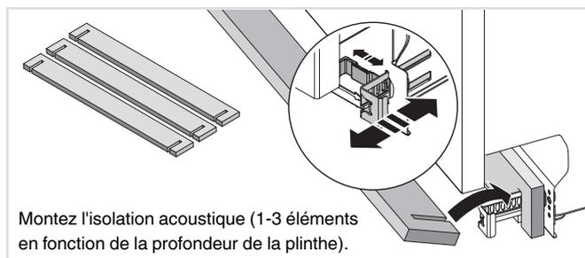
Montez l'isolation acoustique (1-3 éléments en fonction de la profondeur de la plinthe).
