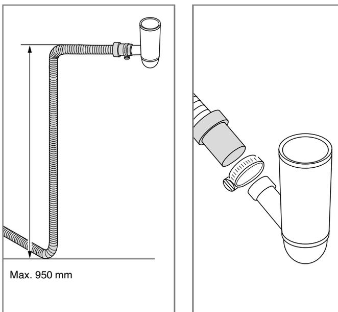
Le tuyau de vidange peut aussi être vissé à un raccord au niveau du siphon de l'évier. Ce raccord doit présenter un diamètre intérieur d'au moins 14 mm.
