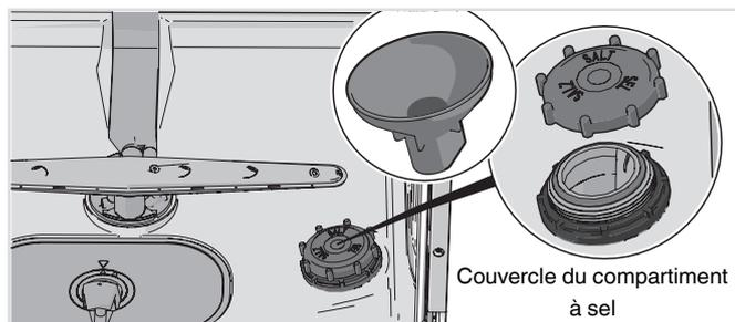
Lorsque la quantité de sel est insuffisante, dévissez le bouchon et remplissez le réservoir de sel. L'eau ne doit être ajoutée que la première fois ! Essuyez l'excédent et serrez. Lancez un programme afin de rincer tout résidu de sel présent dans le lave-vaisselle.
