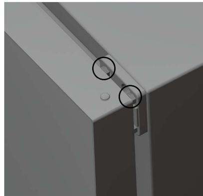
2. Danach die Scharniere mithilfe eines Gabelschlüssels der Grösse 8 leicht lösen, die Türe sauber ausrichten und die Schrauben wieder festziehen.
