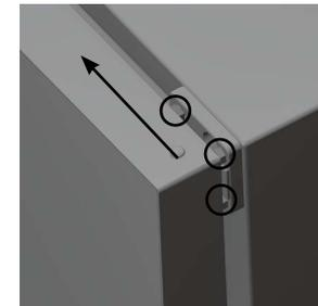
3. Die Scharniere können nun mithilfe eines Gabelschlüssels der Grösse 8 gelöst und dann mitsamt der Türe nach links ausgefahren und ausgehängt werden.
