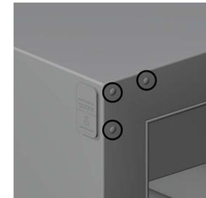
4. Kunststoffabdeckungen über den Schraubenlöchern auf der anderen Seite entfernen und die vorher gebrauchten Löcher stecken.
