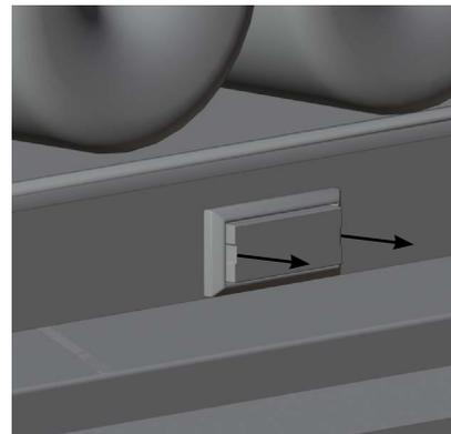
Der Kontaktschalter im Gehäuse kann mit einem kleinen Schraubenzieher erorgehebelt werden, er ist nicht angeschraubt, sondern nur eingesteckt.
