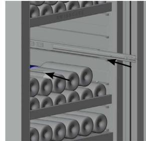
3. Zum wieder einsetzen die Auszugsschienen zurückdrücken, das Tablar beidseitig in die Schienen einfahren und bis an den Anschlag hineinschieben.
