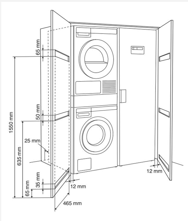
💡 Sorgen Sie dafür, dass die Tür des Wäschetrockners nach der Installation ungehindert geöffnet werden kann.
