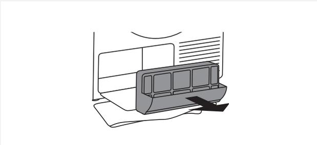
**3** Ziehen Sie mit dem Handgriff den Filter der Wärmepumpe heraus.
