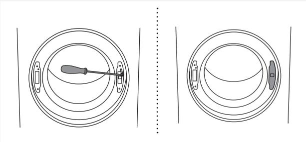
**5** Schrauben Sie die Schraube der Verriegelung ein. Stecken Sie die Blende auf die Lukenverriegelung auf.
