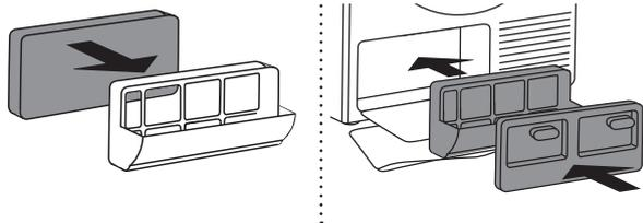
**7** Setzen Sie den Schaumfilter und das Filtergehäuse wieder zusammen.
