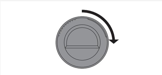
**8** Drehen Sie das Lukenglas um 90°, sodass die Markierung, welche die Öffnungsrichtung anzeigt, auf der anderen Seite liegt.
