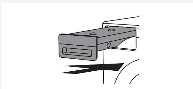
**3** Setzen Sie den Kondenswasserbehälter wieder in das Gehäuse ein.
