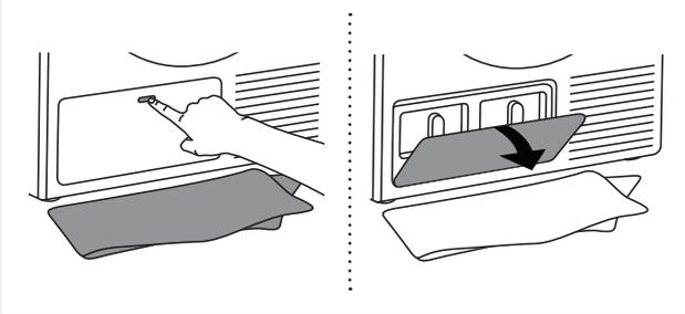
**1** Beim Reinigen kann etwas Wasser aus dem Gerät fließen, deswegen ist es empfehlenswert, ein saugfähiges Tuch auf den Boden zu legen. Öffnen Sie den Außendeckel.
