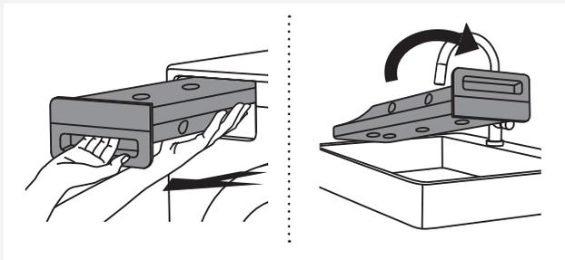
**1** Ziehen Sie den Kondenswasserbehälter aus dem Gerät heraus drehen Sie ihn über dem Waschbecken oder einem Behälter um.
