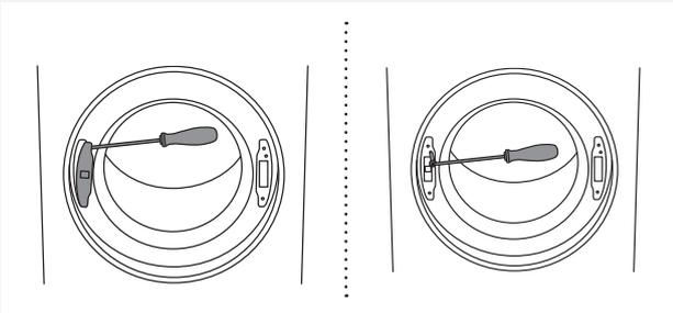
**3** Nehmen Sie mit einem Schraubenzieher die Blende der Lukenverriegelung ab und lösen Sie die Schraube an der Lukenverriegelung.
