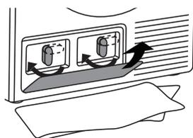
**8** Setzen Sie die innere Abdeckung wieder auf und drehen Sie die beiden Griffe im Uhrzeigersinn in die senkrechte Position. Schließen Sie die äußere Abdeckung.
