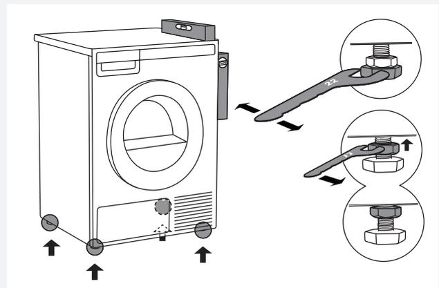
Stellen Sie den Wäschetrockner so auf, dass er stabil ist. Verwenden Sie dazu eine Wasserwaage und richten Sie den Wäschetrockner mit Verstellung der Gerätefüße mit dem Schlüssel 22 (max. 15 mm) in die waagrechte Stellung aus. Ziehen Sie danach die Muttern mit dem Schraubenschlüssel Nr. 17 in Richtung in Richtung zur Unterseite des Geräts fest ↑.
