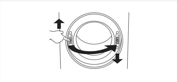
**4** Drücken Sie die Verriegelung nach oben und entfernen Sie diese. Versetzen Sie die Verriegelung auf die andere Seite des Geräts und drücken Sie sie in ihre Lagerung nach unten.
