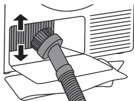
**6** Staub und Schmutz an den Lamellen des Wärmetauschers können mit einem Staubsauger mit einer weichen Saugbürste gereinigt werden. Die Saugbürste beim Saugen vorsichtig in Richtung der Lamellen von oben nach unten bewegen. Ein zu hoher Druck auf die Lamellen kann die Metall-Lamellen des Wärmetauschers verbiegen bzw. beschädigen.
