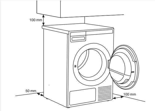
💡 Das Gerät darf die Wand und die benachbarten Küchenelemente nicht berühren. Für eine optimale Funktion des Wäschetrockners empfehlen wir, den Abstand zur Wand, wie auf dem Bild dargestellt, zu berücksichtigen.
