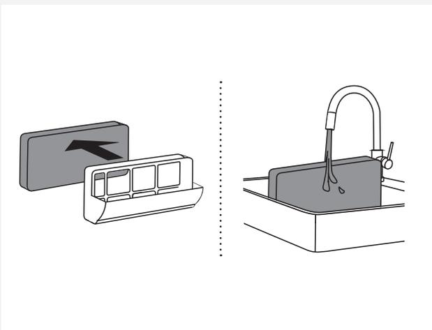
**4** Nehmen Sie den schaumigen Teil des Filters der Wärmepumpe aus dem Gehäuse. Reinigen Sie ihn unter fließendem Wasser und lassen Sie ihn trocknen, bevor Sie ihn wieder in das Filtergehäuse einsetzen.
