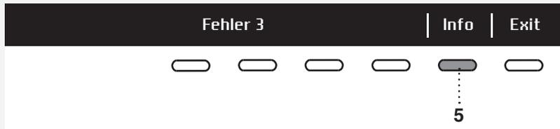
Durch längeres Drücken der Taste 5 INFO wird auf dem Display die Beschreibung des Fehlers angezeigt.
