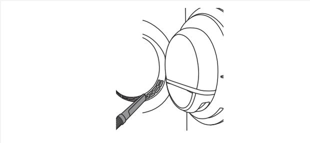
Von Zeit zu Zeit muss die Öffnung an der Unterseite der Luke abgesaugt werden.
