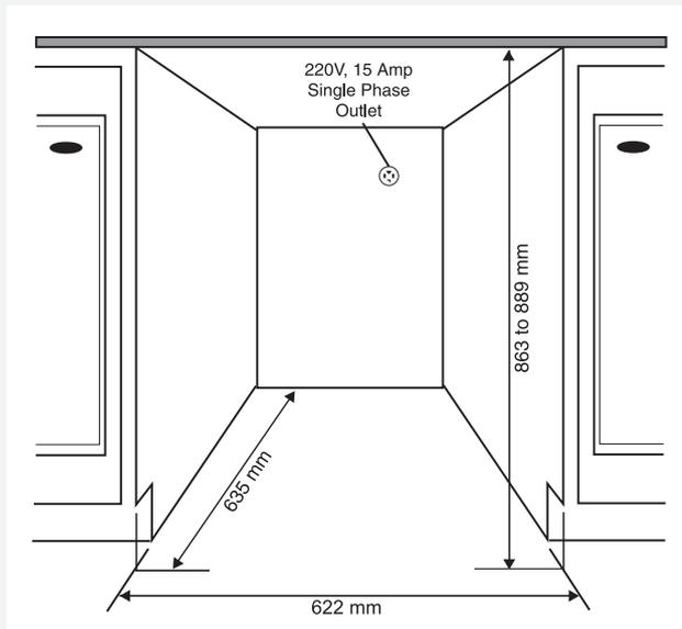
ASKO Wäschetrockner können unter einem Möbelement oder einer Arbeitsplatte mit einer Höhe von mindestens 864 mm eingebaut werden. An allen Seiten des Geräts muss ein Abstand von ca. 12 mm eingehalten werden. Zwischen der hinteren Kante der oberen Geräteplatte und der Wand hinter dem Gerät muss ein Abstand von mindestens 25 mm eingehalten werden. Die Breite der Öffnung bzw. der Nische, in der das Gerät aufgestellt werden soll, muss mindestens 622 mm betragen.
