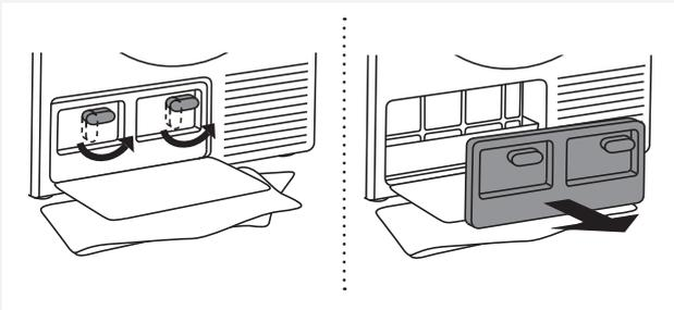
**2** Fassen Sie die Hebel auf dem Innendeckel an und drehen Sie sie nach oben. Nehmen Sie den Innendeckel ab.
