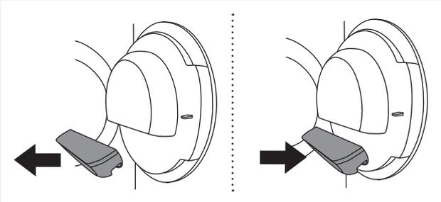
Falls Sie ungewollt das **komplette** Gehäuse des Flusensiebs in der Luke entfernt haben, setzen Sie es wieder in seine Lagerung ein.
