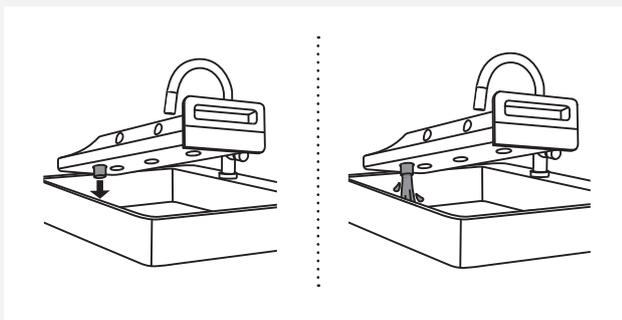
**2** Entleeren Sie das Kondenswasser durch die Auslassöffnung.
