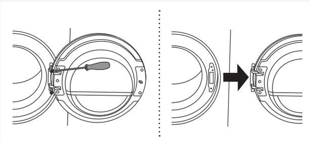
**2** Lösen Sie die beiden Schrauben und nehmen Sie die Luke ab.
