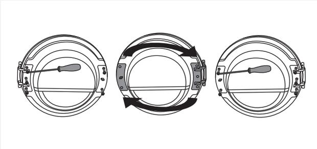
**6** Lösen Sie das Scharniersegment (links) und den die Lukerverriegelung (rechts); tauschen Sie deren Position aus und schrauben Sie sie fest (das Scharniersegment auf die rechte Seite und die Lukerverriegelung auf die linke Seite).
